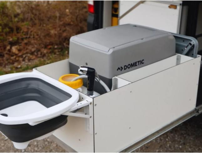
Spülbecken und Wasserknister mit Tauchpumpe für den T5. Das Modul für den Schwerlastauszug bietet Platz für Wasserknister, Spüle und Kühlbox.
